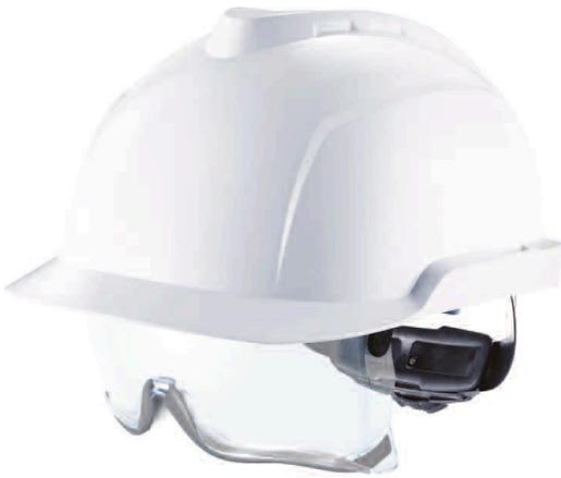
Protección a la cabeza equilibrada, moderna y de perfil bajo con protección ocular integrada, todo en un solo producto sin ventilación, con suspensión de 6 puntos Fas-Trac® III, goggle integrado con ajuste inteligente e innovadora junta de goma. Para el uso donde exista riesgo de impactos superiores en la cabeza, así como riesgo de impactos, rayos UV y polvo para los ojos.
